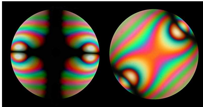
Un análisis más detallado revela que se trata de un cristal de un mineral que tiene 2 ejes ópticos.
