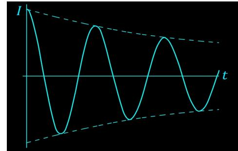
La pérdida media de energía así determinada hace disminuir exponencialmente la amplitud, es decir, la intensidad de radiación de la oscilación del dipolo.
