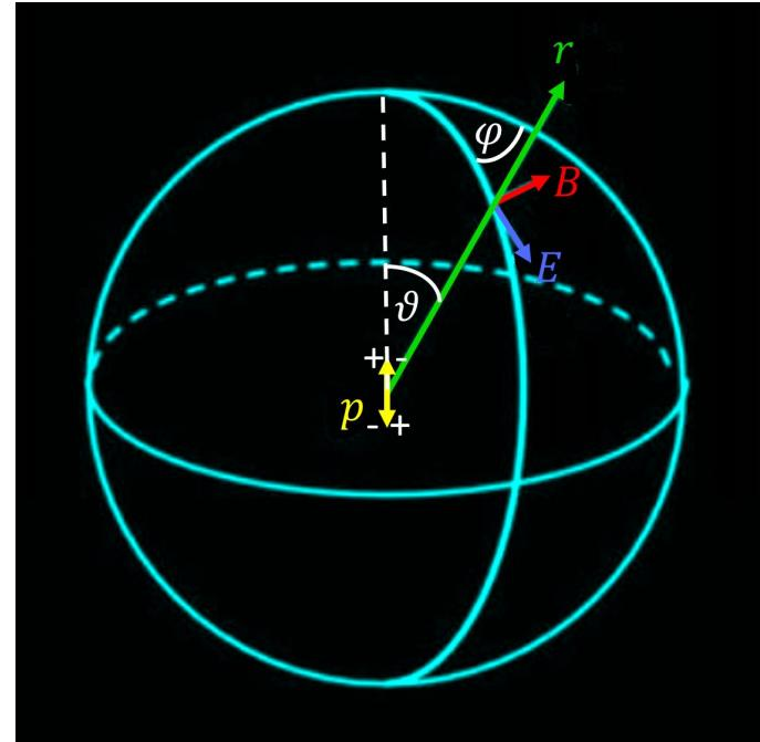
La potencia radiante por área (=intensidad  $I$ ) del dipolo se calcula mediante el vector de Poynting  $S$ .
