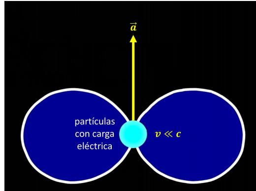
Esta ecuación se denomina fórmula de Larmor. Se utiliza en la física de partículas para calcular la pérdida de energía en aceleradores lineales y circulares. Si la velocidad de las partículas cargadas se aproxima a la velocidad de la luz, la radiación se desplaza hacia delante.
