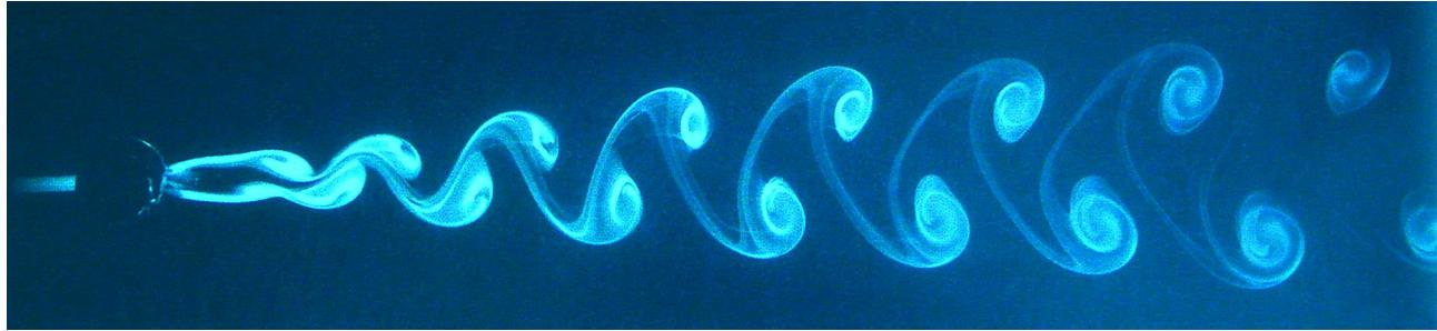
Si un flujo laminar encuentra un obstáculo, pueden formarse vórtices si la velocidad es suficiente. A mas grandes velocidades, es decir, a un número más alto de Reynolds, los vórtices se aflojan y forman una llamada calle de vórtices. En la meteorología esto se puede observar y se llama la calle del vórtice de Kármán. Las islas en el océano o también las cumbres de las montañas son obstáculos y pueden causar la formación de calles de vórtice de Kármán en fuertes corrientes de aire.
