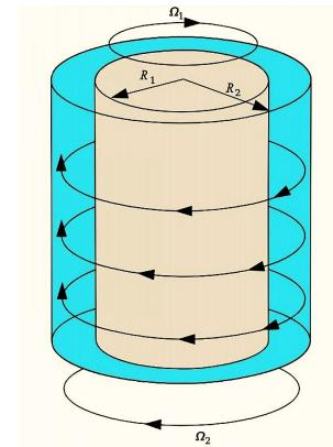
Existe una relación con el número de Rayleigh  $Ra$  y una similitud con el número de Taylor  $Ta$ . La altura de la capa  $h$  y el ancho de la separación ( $R_e - R_i$ ) entran con la 3<sup>a</sup> potencia. Esto es muy importante para las aplicaciones técnicas en forma de cuerpos móviles o giratorios para asegurar que una película lubricante no se interrumpa. Como indicación de la formación de los vórtices, vale:
